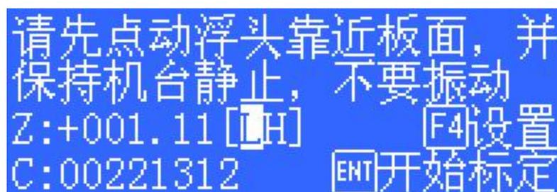
标定前，先把浮头点动到靠近板面（与板面距离大约 1~5mm），并保持板面静止，不要振动。再按<ENT>开始标定。
